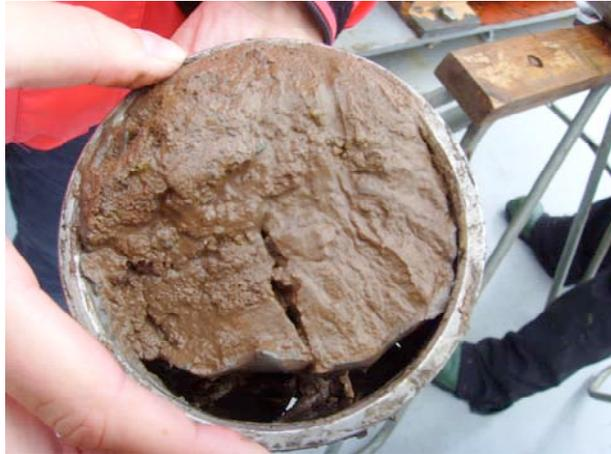
Lors de la remontée, on a pu observer un bout de roche sans doute issue du bedrock pris dans le core catcher. La base de la carotte à piston présente une forte coloration rouge.
